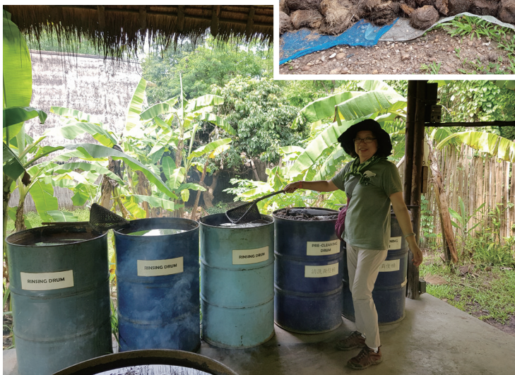
▲象糞纖維較長在各大象營收集，曝曬兩周後送到 EPPPP，牛馬糞纖維較短及少，明顯得見。
