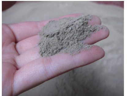
▲ 細緻的土粉是泥漿的主要成分 ◀ 透過篩網從碎土取得更細緻的土粉
